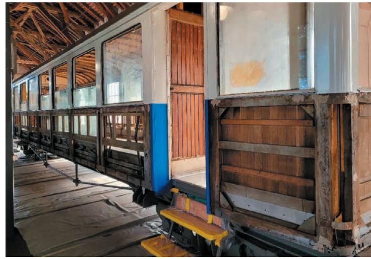
Beim B4 Nr. 52, müssen noch die Aussenbleche montiert werden, bevor als nächstes der Innenausbau folgt...
